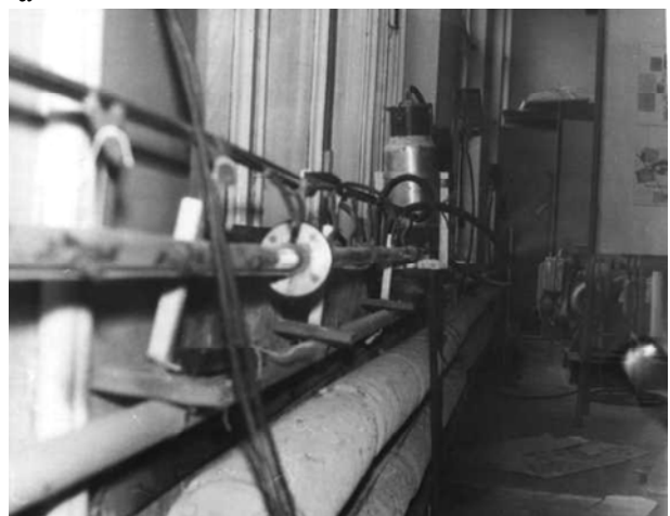
Рис. 1. Экспериментальная пневмотранспортная установка с порционным движением сыпучего материала:
