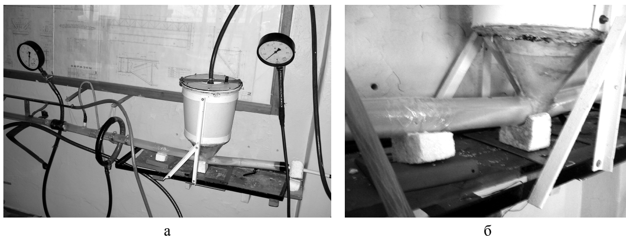
Рис. 4. Модель аэрационно-эжекционного питателя: а – общий вид; б – начало истечения и формирования потока
